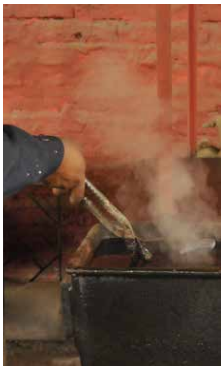
Enfriar la herradura es un proceso delicado, para el cual existe una serie de herramientas como la tenaza de forja.
