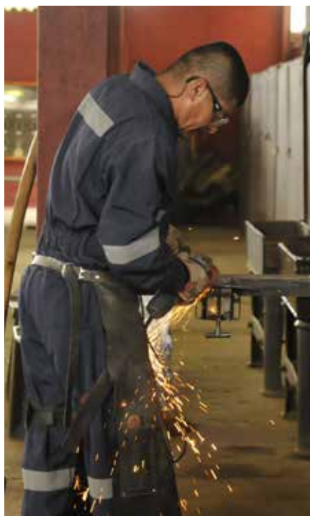
Finalmente se realiza un biselado de la herradura con un galletero. Este proceso garantiza que el caballo no se lastime con la herradura.
