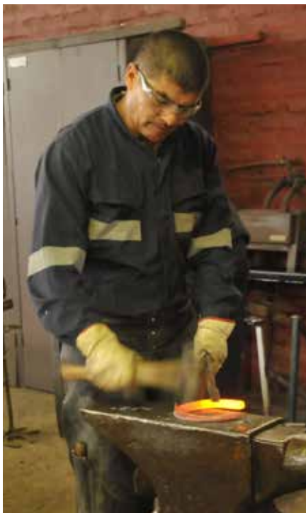
Moldeado de la herradura. Este proceso se realiza sobre un yunque con un martillo.
